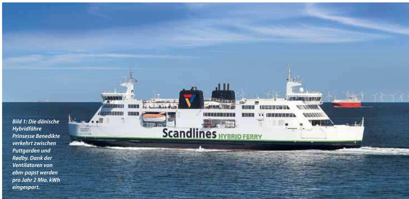
Bild 1: Die dänische Hybridfähre Prinsesse Benedikte verkehrt zwischen Puttgarden und Rødby. Dank der Ventilatoren von ebm-papst werden pro Jahr 2 Mio. kWh eingespart.
