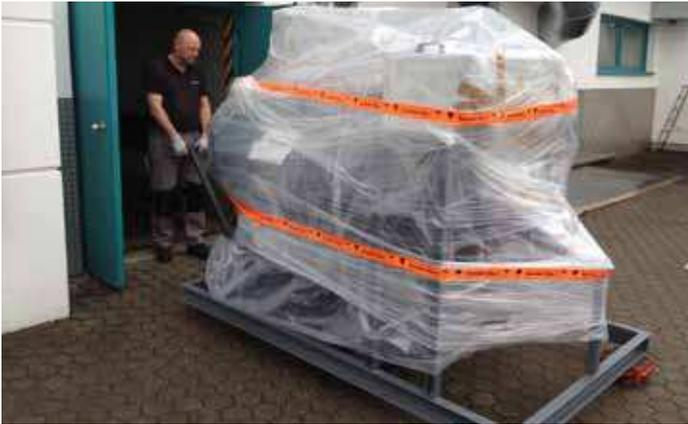
*Der Austausch der Anlage musste über einen vorhandenen Lastenaufzug mit festen, vorgegebenen Maßen und beschränkter Förderlast erfolgen.*
