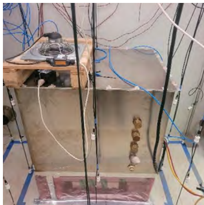
Abbildung 56: Links: LCR290-Demonstrator in seinem „dichten“ Gehäuse; oben am Demonstrator ist der interne Raumventilator zu sehen. Dieser wird für eine ideale Durchmischung im Aufstellungsraum eingesetzt, um eine Bilanzierung der aus dem Gehäuse freigesetzten Mengen zu bestimmen. Rechts: Schema zur Kampagne 1.
