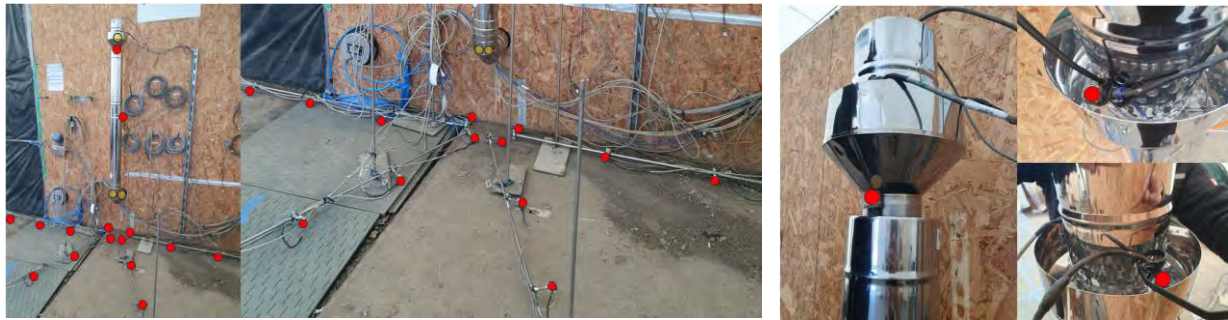
Abbildung 55: Übersicht über die Sensorpositionen im Prüfstand für Außenwärmepumpen
