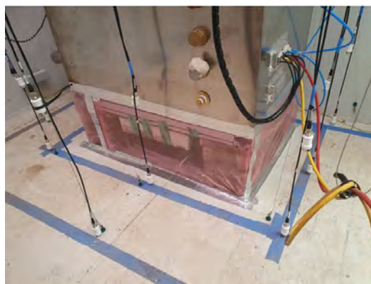
Abbildung 67: Abgedichteter Raum unter dem erhöhten Demonstrator HP
