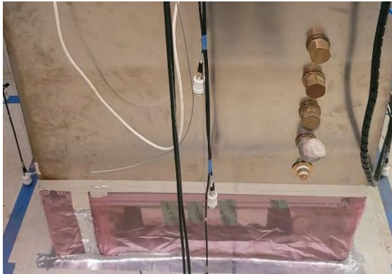
Abbildung 47: Abdichtung des Raums unter dem Schweißtank
