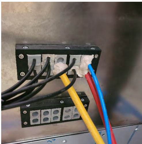
Abbildung 48: Schläuche für die Gasversorgung mit Propan (rot) und Stickstoff (gelb), Durchführung durch den Schweißtank (links), Positionierung im DuT (rechts)
