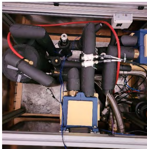
Abbildung 48: Schläuche für die Gasversorgung mit Propan (rot) und Stickstoff (gelb), Durchführung durch den Schweißtank (links), Positionierung im DuT (rechts)
