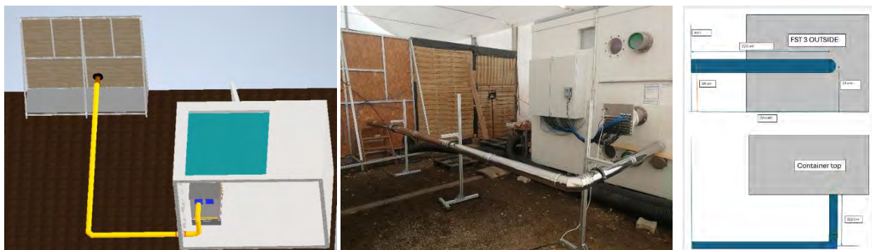
Abbildung 54: Verbindung zwischen den zwei Prüfständen für die Freisetzung – für die Innen- und Außenaufstellung von Wärmepumpen, Abstandsmessungen (rechts)
