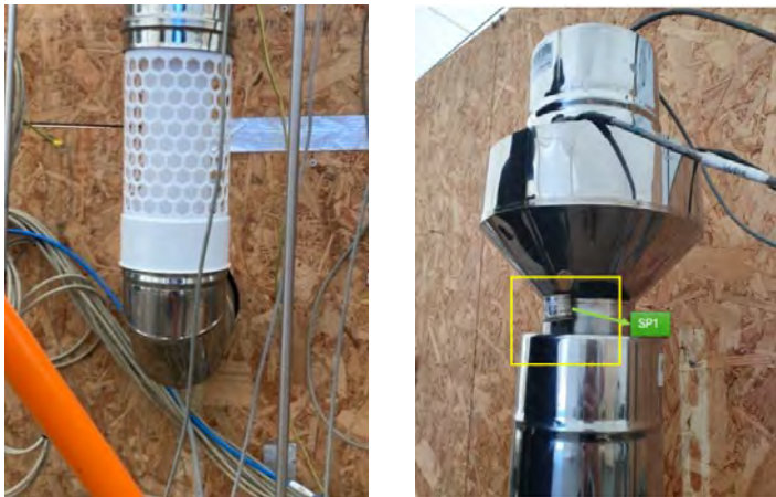
Abbildung 62: Lufteinlass und Bypass-Sperring
