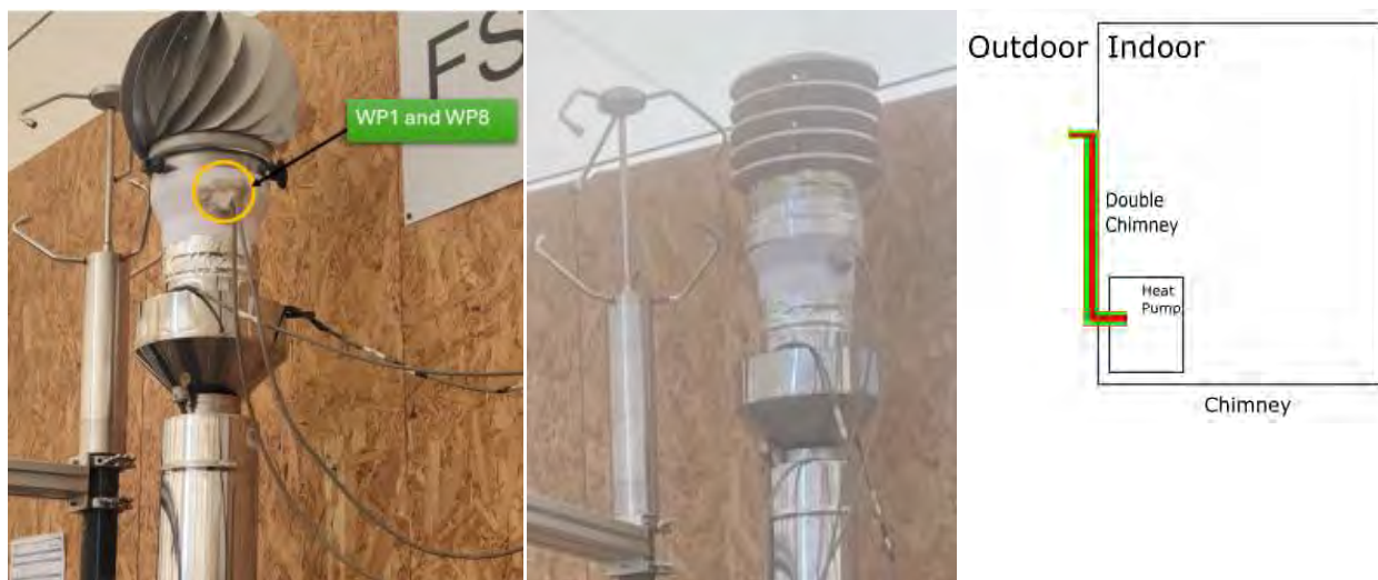
Abbildung 64 : Getestete Kaminabdeckungen: Ausführung mit rotierendem Ventilator (links) und Ausführung mit feststehender Regenhaube (mittig). Schema der Kampagne 4 (rechts)
