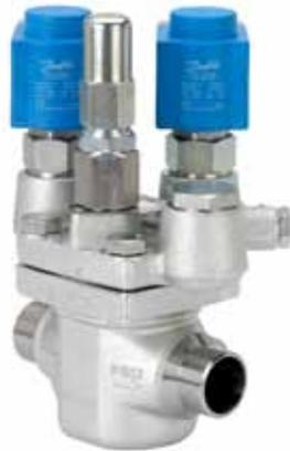
Stufe eins aktiviert wird, öffnet das Hauptventil auf ca. 20% der maximalen Durchflusskapazität. Erst nach einer vordefinierten Verzögerung wird ein weiteres „EVM-NC“ für die zweite Stufe aktiviert und öffnet das Ventil vollständig. Das zweistufige „ICSH“-Magnetventil ist auf der „ICV“-Plattform aufgebaut. Lediglich der Kopfdeckel macht den Unterschied.
