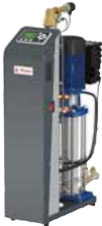
gieeinsparungen. Zu verdanken ist dies der vollautomatischen Systemüberwachung mittels Sensoren, die kontinuierlich Temperatur und Druck messen und somit das effektivste Vakuum errechnen. Sensoren optimieren den Entgasungsprozess und vermeiden so die Entstehung von Wasserdampf. Nur die im Wasser gelösten Gase werden abgeschieden. Vorteilhaft ist auch die automatische Standby-Funktion: Die Sensoren erkennen, wie viel
